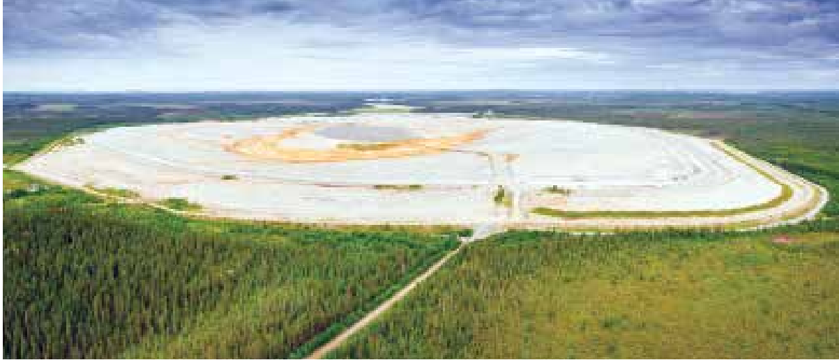
Agnico Eagle ja Quebecin hallitus keksivät isännättömän Manitou alueen rikastushiekan aiheuttamaan ympäristön happamoitumiseen innovatiivisen ratkaisun, jossa rikastushiekka-alue peitetään Goldexin kaivoksen sulfidittomalla ja syanidittomalla rikastushiekalla.
